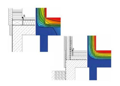
WANDTYP/TIPO DI PARETE A.7 ZIEGELMAUERWERK, MIT AUSSENDÄMMUNG MURATURA IN LATERIZIO CON COIBENTAZIONE esterno Der Bauanschluss ist hinsichtlich Feuchte Valutare II dettaglio da un punto di vista beheizt BESCHREIBUNG BESCHREIBUNG DESCRIZIONE DESCRIZIONE Stahlbeton - Cls armato Porenbetonsteine Putz - Intonaco Hochlochziegel porosiert Voliziegel - Mattone pieno
